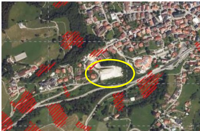
Abbildung 10: Auszug aus der Gefahrenhinweiskarte zur Anfälligkeit von flachgründigen Hangabbrüchen (Quelle: LfU; https://www.umweltatlas.bayern.de , 12.09.2023)
