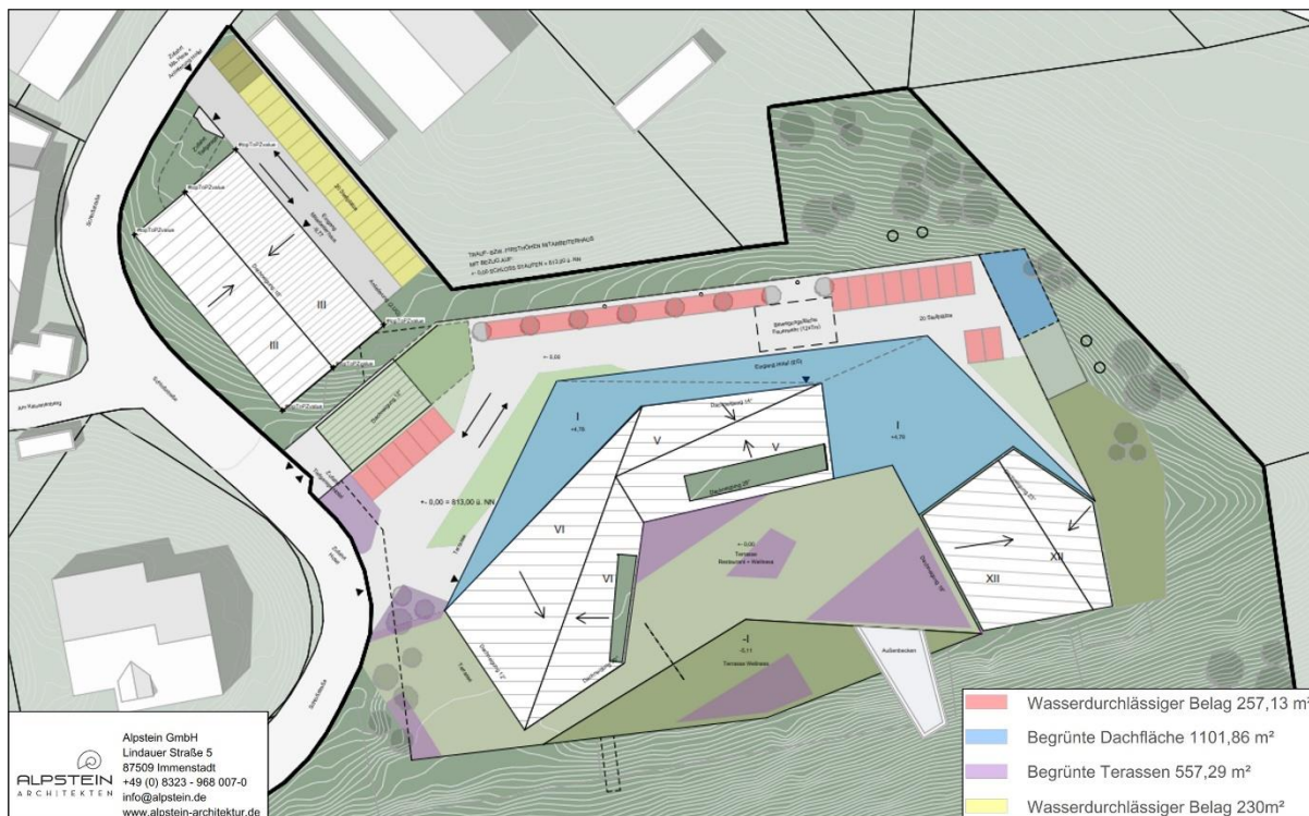
Abbildung 17: Graphische Darstellung von Vermeidungsmaßnahmen, zur Anrechnung auf den Planungsfaktor, Quelle: Alpestein Architekten
